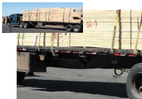
Obr.: 4: Vypodloženie väzníkov na korbe nákladného vozidla spôsobilo ich nežiadúcu deformáciu.
